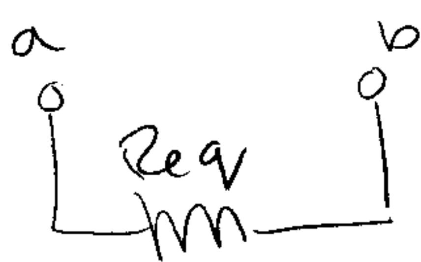
$$R_{eq} = R_T = \left( R_1^{-1} + R_4^{-1} + R_5^{-1} \right)^{-1}$$
