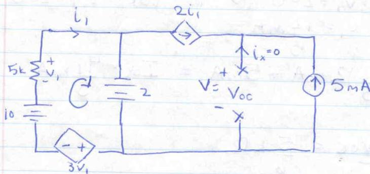
$$\text{KVL: } 10 + V_1 + 2 - 3V_1 = 0 \Rightarrow 12 + (5k \cdot i_1) - 3V = 0$$
