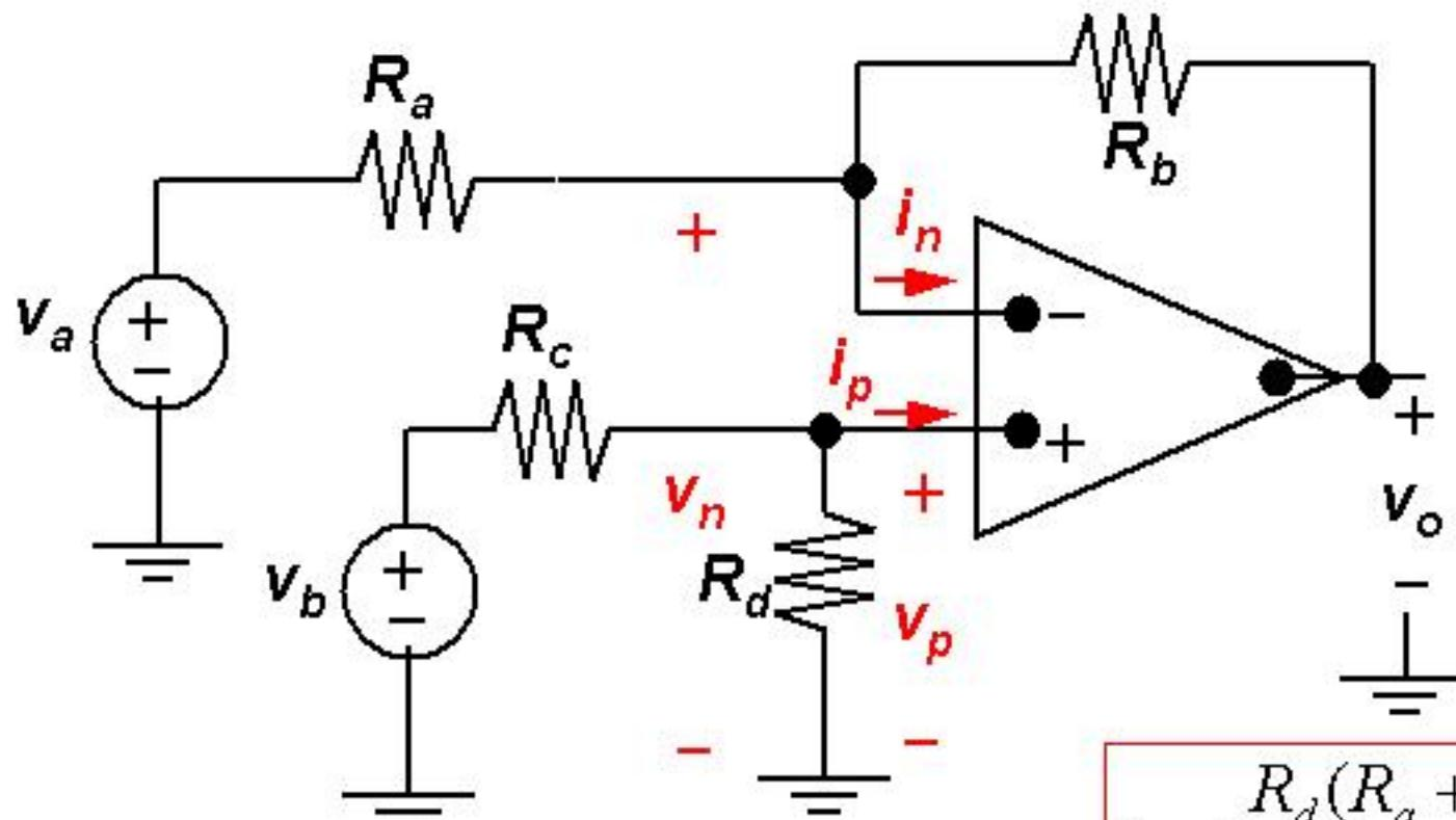
$$i_n = 0 \rightarrow \frac{v_n - v_a}{R_a} + \frac{v_n - v_o}{R_b} = 0$$
