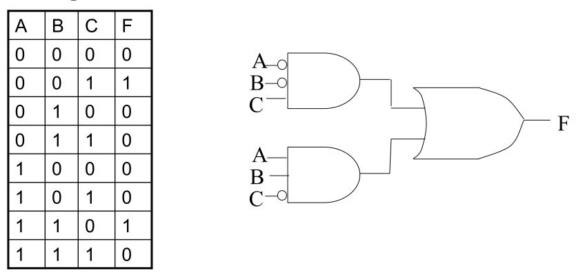
$F = \overline{A} \overline{B}C + AB\overline{C}$
