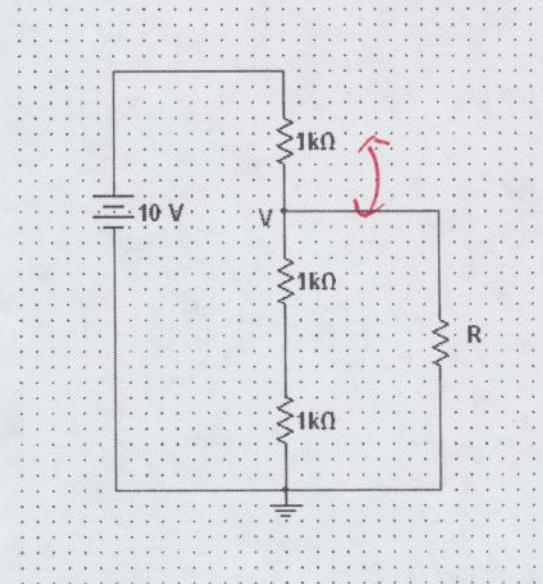
$$\begin{aligned} V &= 5V \\ R_{eq} &= \frac{2k\Omega}{2k\Omega + R} \\ 5V &= 10 \cdot \frac{2k\Omega}{2k\Omega + R} \\ 5V &= \frac{2k\Omega}{2k\Omega + R} + 1k\Omega \\ R &= 2k\Omega \end{aligned}$$
