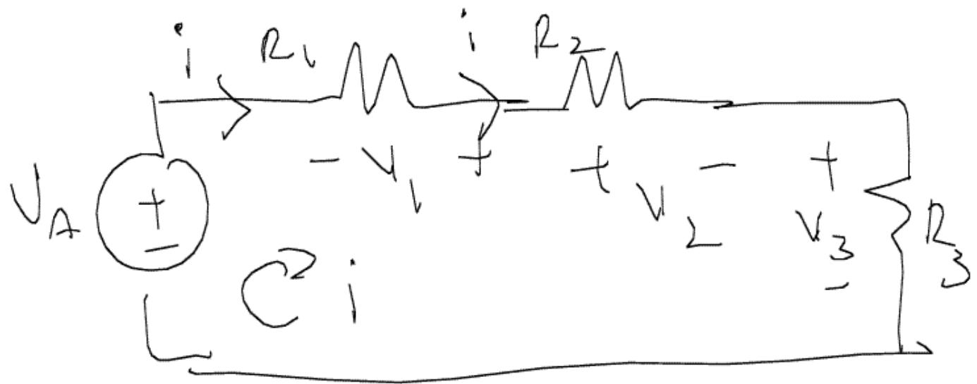
$$\text{KVL: } V_A + V_1 - V_2 - V_3 = 0$$
