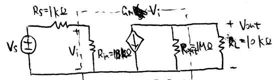
$$A_v = - \frac{R_{in}}{R_s + R_{in}} \cdot G_m \cdot \frac{R_{out} \cdot R_L}{R_{out} + R_L} = - \frac{113k\Omega}{1k\Omega + 113k\Omega} \cdot 0.885mS \cdot \frac{1M\Omega \cdot 10k\Omega}{1M\Omega + 10k\Omega}$$
