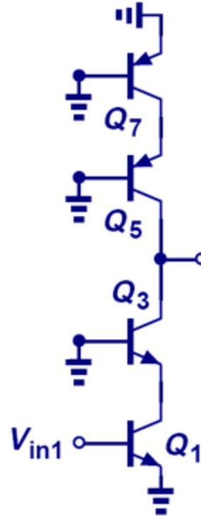
$$A_v \approx -g_{m1} [g_{m3} r_{O3} (r_{O1} \parallel r_{\pi3})] \parallel [g_{m5} r_{O5} (r_{O7} \parallel r_{\pi5})]$$
