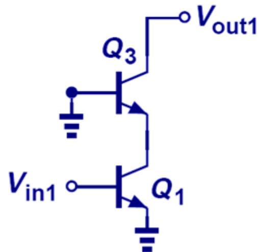
$$A_v = -g_{m1}R_{out} \cong -g_{m1}[g_{m3}(r_{O1} \parallel r_{\pi3})r_{O3} + r_{O1} \parallel r_{\pi3}]$$
