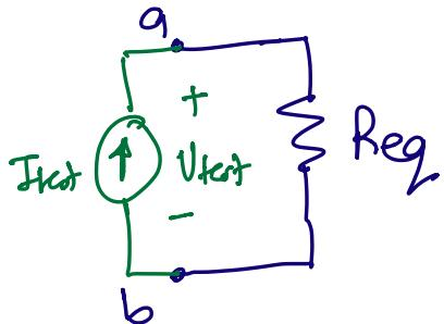
$$V_{\text{test}} = I_{\text{test}} \cdot (R_{\text{eq}})$$
