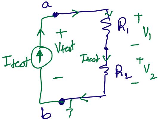
$$V_1 = I_{\text{test}} \cdot R_1$$
