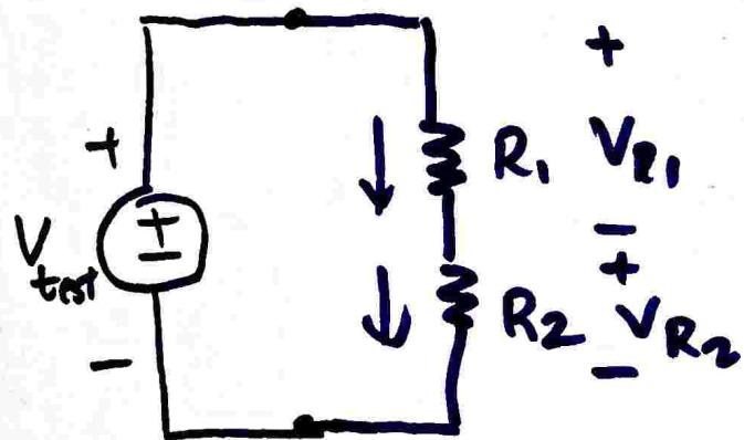
$$V_{\text{test}} = \underbrace{(R_1 + R_2)}_{R_{\text{eq}}} I_{\text{test}}$$
