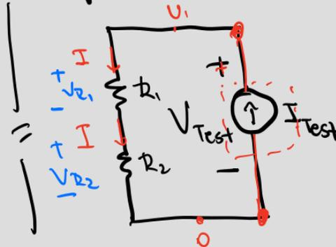
$$V_{TEST} = V_{R1} + V_{R2}$$
