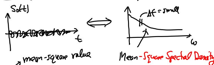
$$S_o(\omega) = [H(j\omega) H^*(j\omega)] S_i(\omega) = |H(j\omega)|^2 S_i(\omega)$$
