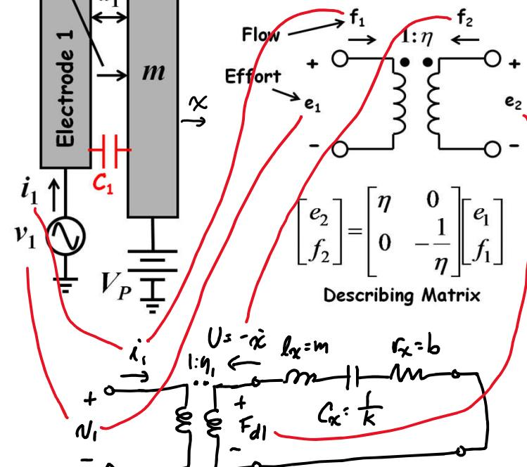
$$\begin{bmatrix} e_2 \\ f_2 \end{bmatrix} = \begin{bmatrix} \eta & 0 \\ 0 & -\frac{1}{\eta} \end{bmatrix} \begin{bmatrix} e_1 \\ f_1 \end{bmatrix}$$
