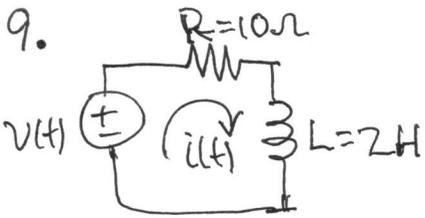
$$I_L(t) = \frac{V(t) - V_L(t)}{R}, \quad V_L(t) = L \frac{dI_L(t)}{dt}$$
