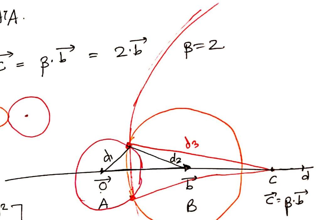
$$2 \begin{bmatrix} \vec{b}^T - \vec{a}^T \\ \vec{c}^T - \vec{a}^T \end{bmatrix} = \begin{bmatrix} d_1^2 - d_2^2 - \|\vec{q}\|^2 + \|\vec{b}\|^2 \\ d_1^2 - d_2^2 - \|\vec{q}\|^2 + \|\vec{c}\|^2 \end{bmatrix}$$
