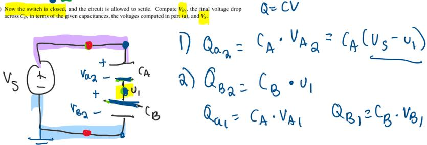
@  $V_1$ :  $-Q_{A2} + Q_{B2} = -Q_{A1} + Q_{B1}$
